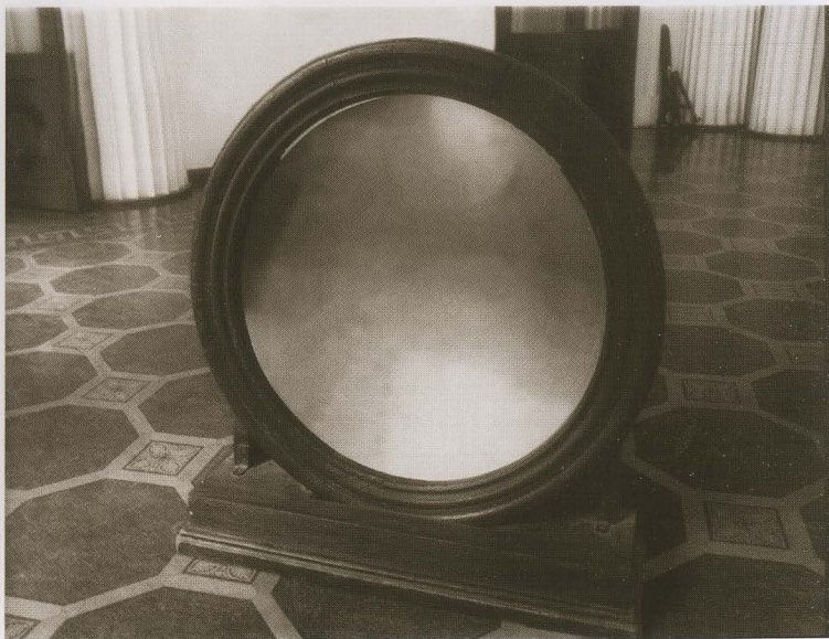
Металлическое зеркало для ньютоновского телескопа, изготовленное Я. Брюсом
